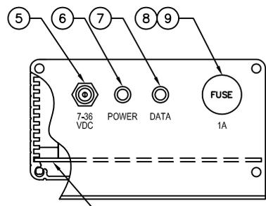
INSTALL PCB IN BOTTOM SLOT
